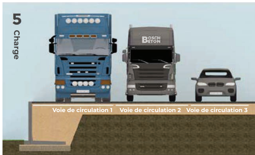
5 Charge Distance des bords ≥ 1,00 m. Voie de circulation 1 : TS = 300 kN charge à l'essieu (40,00 kN/m 2 ) ; UDL (12 kN/m 2 ). Voie de circulation 2 : TS = 200 kN charge à l'essieu (26,67 kN/m 2 ) ; UDL (6 kN/m 2 ) Voie de circulation 3 : TS = 100 kN charge à l'essieu (13,33 kN/m 2 ) ; UDL (3 kN/m 2 )
